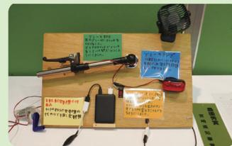
自転車を漕ぐ力を使ってブレーキライトが点灯するようになりました。また、災害時でも使えるようにUSB出力を付け、スマートフォンの充電・扇風機・ライトなどに使用することができます。
